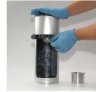
2. FillClean-Abfüllzylinder auf Sprühdose setzen
