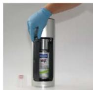
7. Nach Abfüllung die Kappe aus dem Abfüllzylinder entnehmen. Das Pad verbleibt in der Kappe zur Farborientierung.
